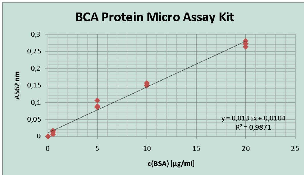
Abbildung 1: Exemplarische Darstellung der BSA-Kalibrierungskurve für 30 Min. Inkubationen bei 37 °C.
