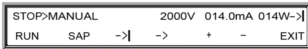
Bild 4: Anzeige der Sollwerte der elektrischen Parameter MANUAL-[STOP]
